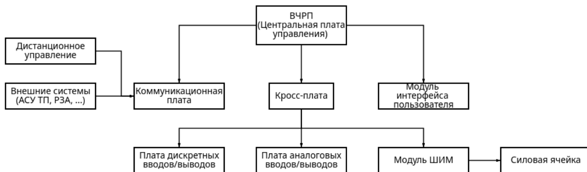
Рис. 2.1 – Блок-схема модулей, с которыми взаимодействует ВЧРП
